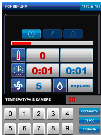
Рис.13.Редактирование параметра « ТЕМПЕРАТУРА В КАМЕРЕ »
