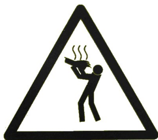
Рис.2.1 Наклейка «Опасность ошпаривания»
